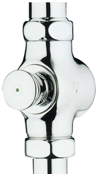
Presto ECLAIR åpen Toalettskylling 1 ¼'' 6-9 liter pr spyling, justerbart Skylletid: 7-9 sekunder Ref. 13001 Varenr. 35295
